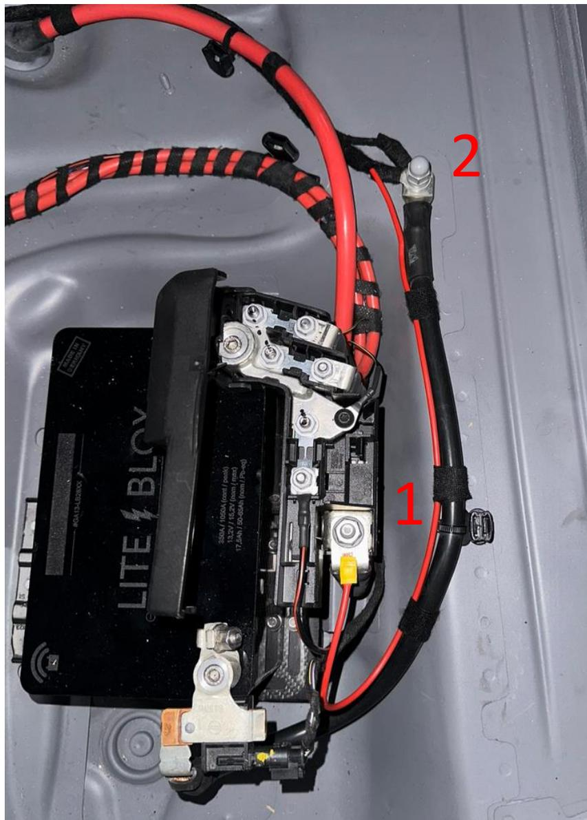
Als letzter Punkt wird das Plus Kabel an dem Punkt 1 und das Massekabel an Punkt 2 angeschlossen.
