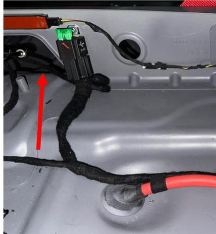
Gehen Sie mit dem Kabel durch das Tunnel an der Trennwand, führen es Richtung Kraftstoffpumpe und Verbinden das Kabel mit der HPerformance Kraftstoffpumpe.
