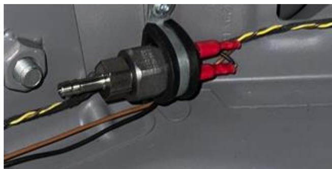
Stecken Sie die zwei roten Stecker an den Druckschalter an und verbinden diesen mit Ladedruck.
