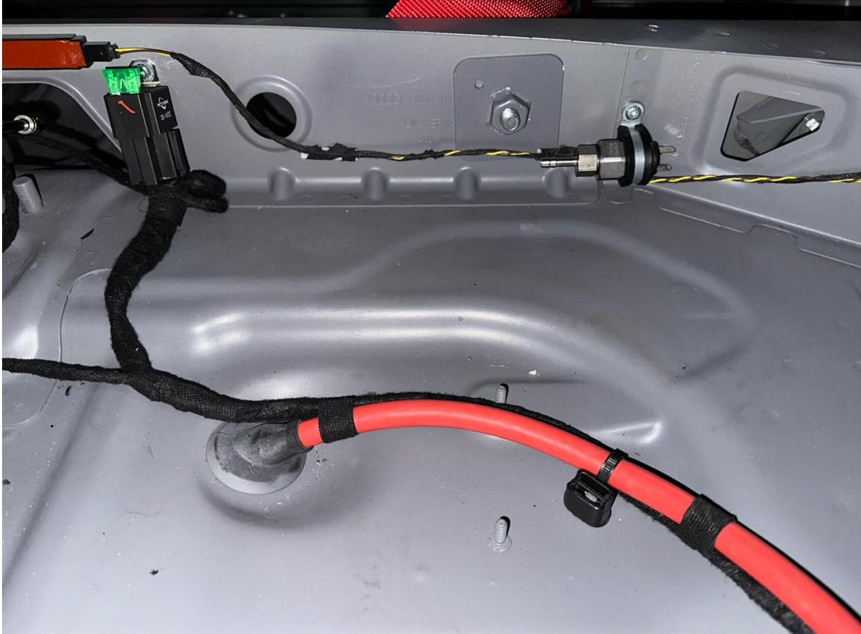
Das Relais und der Druckschalter an den Befestigungspunkten wie auf dem Bild zu erkennen ist montieren.
